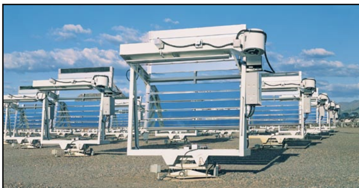
Les conditions d'exposition naturelles extrêmes accélèrent le vieillissement du produit deux à trois fois plus vite que sous un climat « standard »
