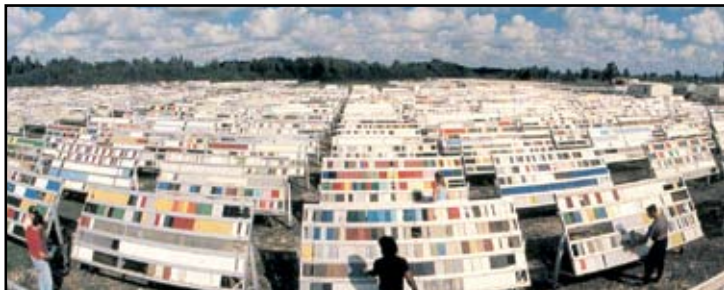
Paneles de prueba especialmente diseñados en la planta del Atlas Weathering Services Group en Florida, EE UU.
