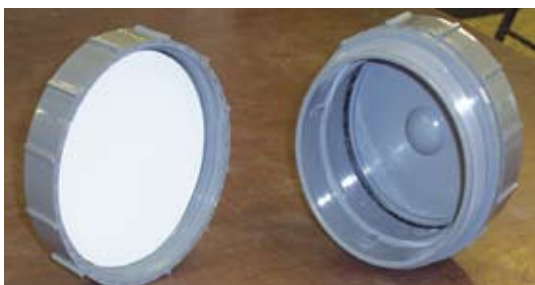
Echantillon circulaire de stratifié, utilisé pour tester la résistance à l'osmose du gelcoat
