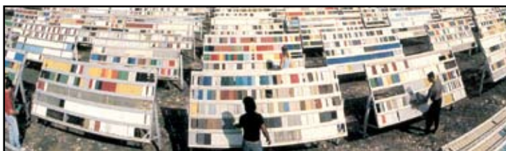
Panneaux spécialement conçus pour le test sur le site de Atlas group weathering en Floride (USA)
