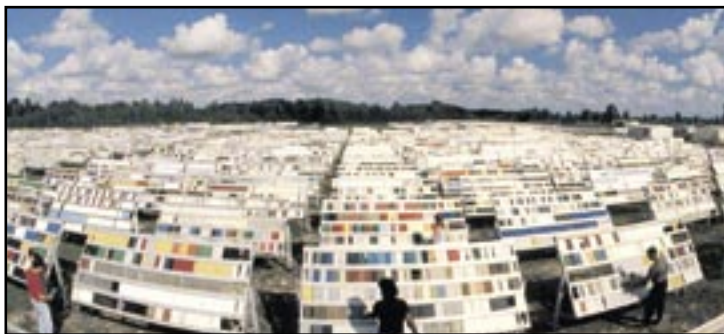
Pannelli di test appositamente progettati nell'impianto Atlas Weathering Services Group, in Florida (Stati Uniti).
