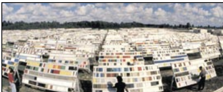
Speziell entwickelte Testtafeln am Aufstellungsort „Atlas Weathering Services Group“ in Florida, USA.
