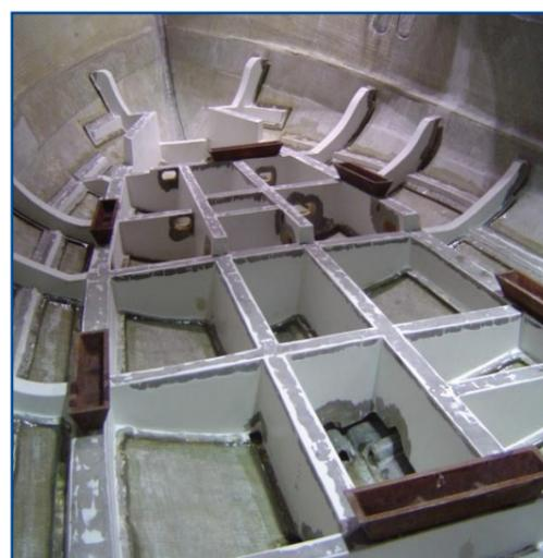
**9** Use pesos si es necesario para sujetar el conjunto de costillas mientras Crestomer cura.
