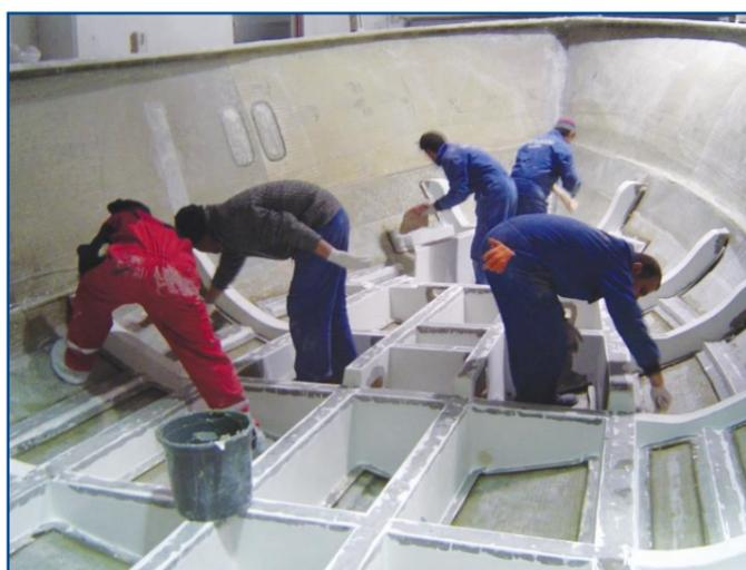
**7** Reajuste el conjunto de costillas en la adhesivo, asegurándose de que Crestomer toca el casco y los costillas.
