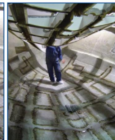
**2** Coloque el conjunto de costillas en el casco seco para asegurar un ajuste correcto y señale las áreas de pegado en el casco.
